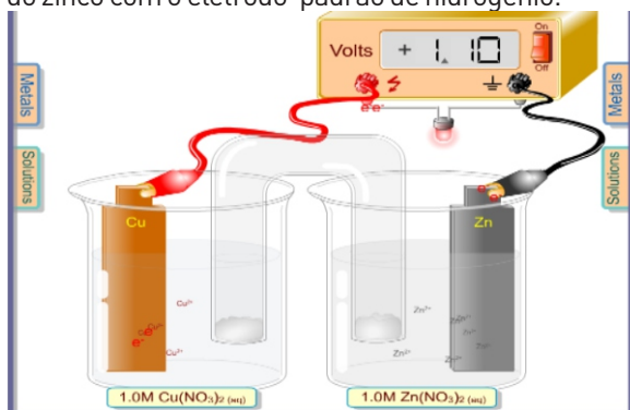
Figura 08 - Simulador da célula galvânica Fonte: PhET - Interactive Simulations_ University of Colorado Boulder.
