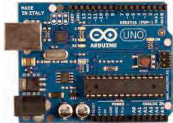
Figura 2: Placa Arduino UNO.
