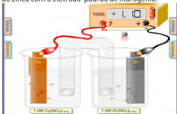
**Figura 08** - Simulador da célula galvânica
